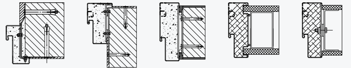
外加预埋件焊接 D2型 角框连接 E型 反侧角框连接 F型 包墙框连接
